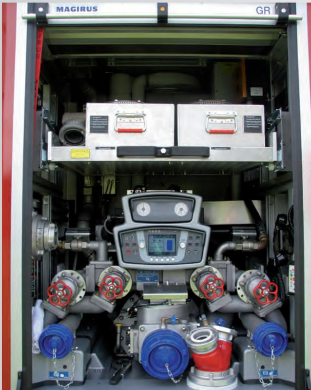
Feuerlöschkreiselpumpe im Fahrzeugheck
