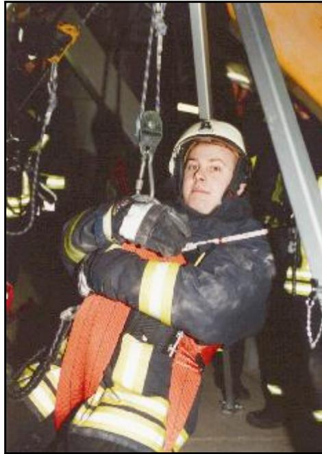
ist ähnlich wie ein Flaschenzug aufgebaut, man braucht daher nur das halbe Gewicht zu ziehen. Das Gerät besitzt eine eingebaute Bremse, die die Ablassgeschwindigkeit herabsetzt, so dass auch wenn das Seil losgelassen wird, die zu bewegende Last nicht unkontrolliert abstürzt. Das Abseilret-
