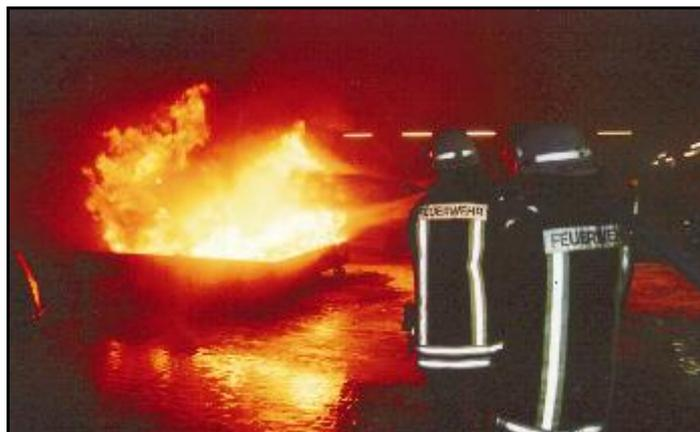
Löschangriff mit Sprühwasser auf eine 5 x 5 m große mit Kraftstoff gefüllte Wanne.
