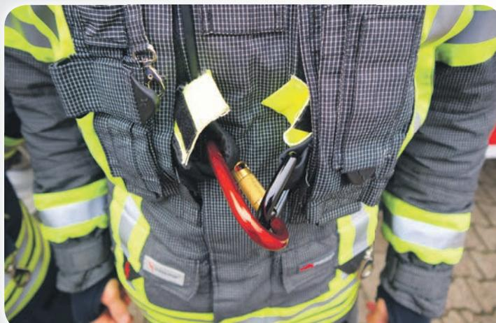
jeden Feuerwehrmann wurde die Schutzbekleidung maßangefertigt, um größtmöglichen Tragekomfort und größtmögliche Sicherheit zu gewährleisten. Ein weiterer Vorteil der neuen sowie der vorangegangenen Einsatzschutzkleidung ist ein integrierter Multifunktionsgurt. Der kann auf Brusthöhe der Brandschutzjacke integriert und an zwei Öffnungen herausgezogen werden. Es bietet verschiedenste Funktionen von Halten und Rückhalten, Selbst-
